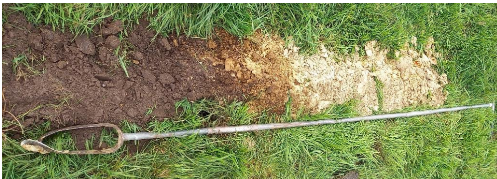
Boorprofiel JS1 (de Vries & Medenblik, Veldwerk bodemboringen Twijzel, 2023)
